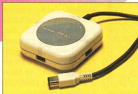
Für Spielspaß zu viert braucht Ihr diesen Vier-Spieler-Adapter für den Game Boy
