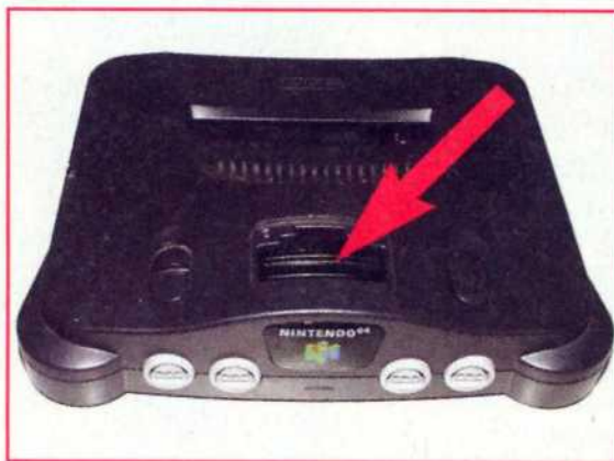
Einfache Installation: Das neue "4 MB Extension Pak" stöpselt Ihr in den Erweiterungsschacht an der Oberseite Eures N64.
