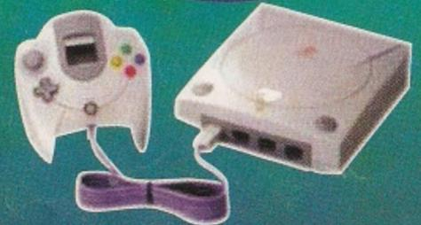
*Processamento de gráficos é a especialidade do novo console da Sega. Com 128 bits e memórias RAM separadas para a CPU e o processador gráfico, o Dreamcast é capaz de ler 3 milhões de polígonos por minuto*
