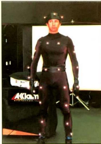
An diesem hautengen Overall befinden sich die lichtreflektiven Sensoren, die die notwendigen Daten für das zu berechnende 3D-Skelett liefern.
