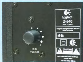
Z-540 重低音喇叭上有一個重低音旋鈕，可單獨調整重低音的音量大小。
