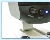
左邊的旋鈕是 Z-540 的主音調節鈕，喇叭的電源 (Power) 打開後，會亮起藍色的電源指示燈。
