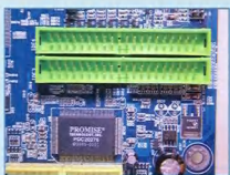
Promise 的 PDC2076 晶片，支援 ATA-133 的 IDE RAID 磁碟陣列功能
