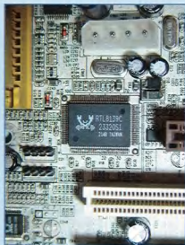
偉格 SL-85MIR-L 採用 Realtek RTL8139C 網路晶片
