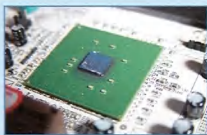
偉格 SL-85MIR-L 採用 Intel 整合型晶片組 i845G
