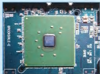
技嘉 GA-8IEXP 採用 Intel i845-E 晶片組
