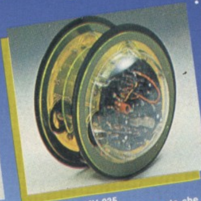
CIRCULAR MV-935 È provvisto di due grandi ruote che gli permettono di ruotare in avanti, a destra, a sinistra e su se stesso. Tutti i movimenti sono controllati mediante un comando a distanza.
