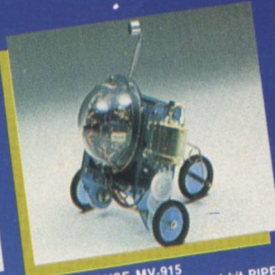
PIPER MOUSE MV-915 Usando un fischietto unito al kit PIPER MOUSE eseguirà immediatamente i comandi comunicativi: sinistra, stop, destra, stop, avanti e stop.
