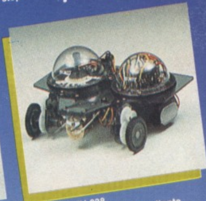
NAVIUS MV-938 È un robot controllato mediante dischetti programmabili. È in grado di riconoscere il bianco e il nero del dischetto programmato e quindi muoversi in avanti, a destra, a sinistra o fermarsi.
