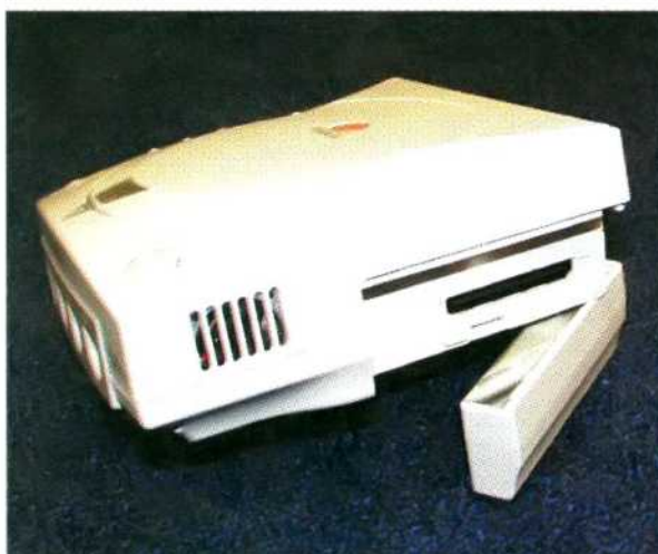
Dreamcast von der Seite: links der Lüfter, rechts der Expansion-Port.
