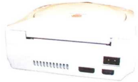
Die hinteren Anschlüsse des Dreamcast beschrän- ken sich auf den Strom- anschluß, den Multiout- Port und einen seriellen Port (für eventuelle Link- und Netzwerk-Spiele).
