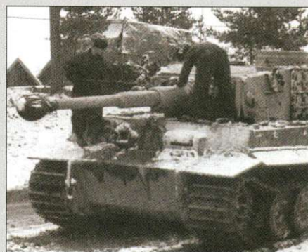
⬆ Der "Tiger" wurde 1941 erstmals gebaut: Henschel konstruierte das völlig neue Fahrgestell, während Krupp den Turm entwickelte. Die Panzerung wurde so konstruiert, dass die meisten Projektile und Granaten an der schrägen Oberfläche abprallten. Obwohl der erste Einsatz des "Tigers" ein kompletter Fehlschlag war, und ihn Designfehler leicht verwundbar machten, galt er in der deutschen Öffentlichkeit als nahezu unbesiegbar.
