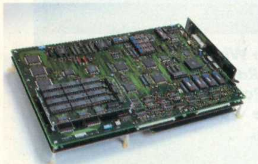
Das System 22-Board enthält auch eine Huckepack-160 Megabit-ROM-Platine, die praktischerweise Namcos zusätzlichen Grafikchip verdeckt.
