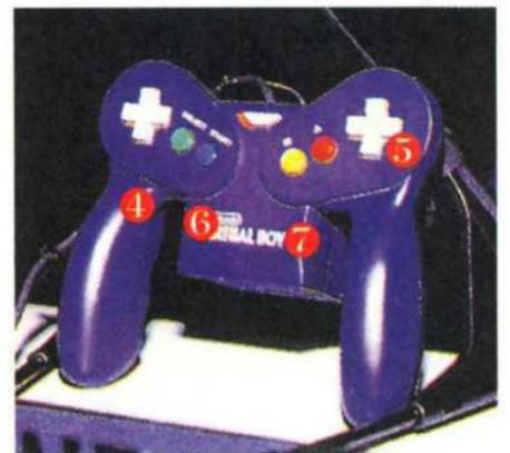
• **Der Virtual Boy kann batterie- oder netzbetrieben werden. Auf dem „griffigen“ Joypad befinden sich zwei Steuerkreuze für vertikale und horizontale Bewegung (4) und Bewegung in die Raumbtiefe (5), Start- und Select-Knöpfe (6) sowie zwei Aktionstasten (7).**
