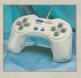
Allzuviel Zusatzfähigkeiten hat InterAct dem PS Game Pad 8 nicht gegönnt. Lediglich ein "Semi-Auto"-Feuer und ein Zeitlupenschalter an der Unterseite unterscheidet das Knopf- und Schalterangebot von dem des Standard-Pads. Dabei hat sich der Hersteller bemüht, dem Ganzen eine noch ergonomischere Form zu geben und Mulden für die Finger eingelassen. Das Kabel hat die übliche "Extra-Länge".
