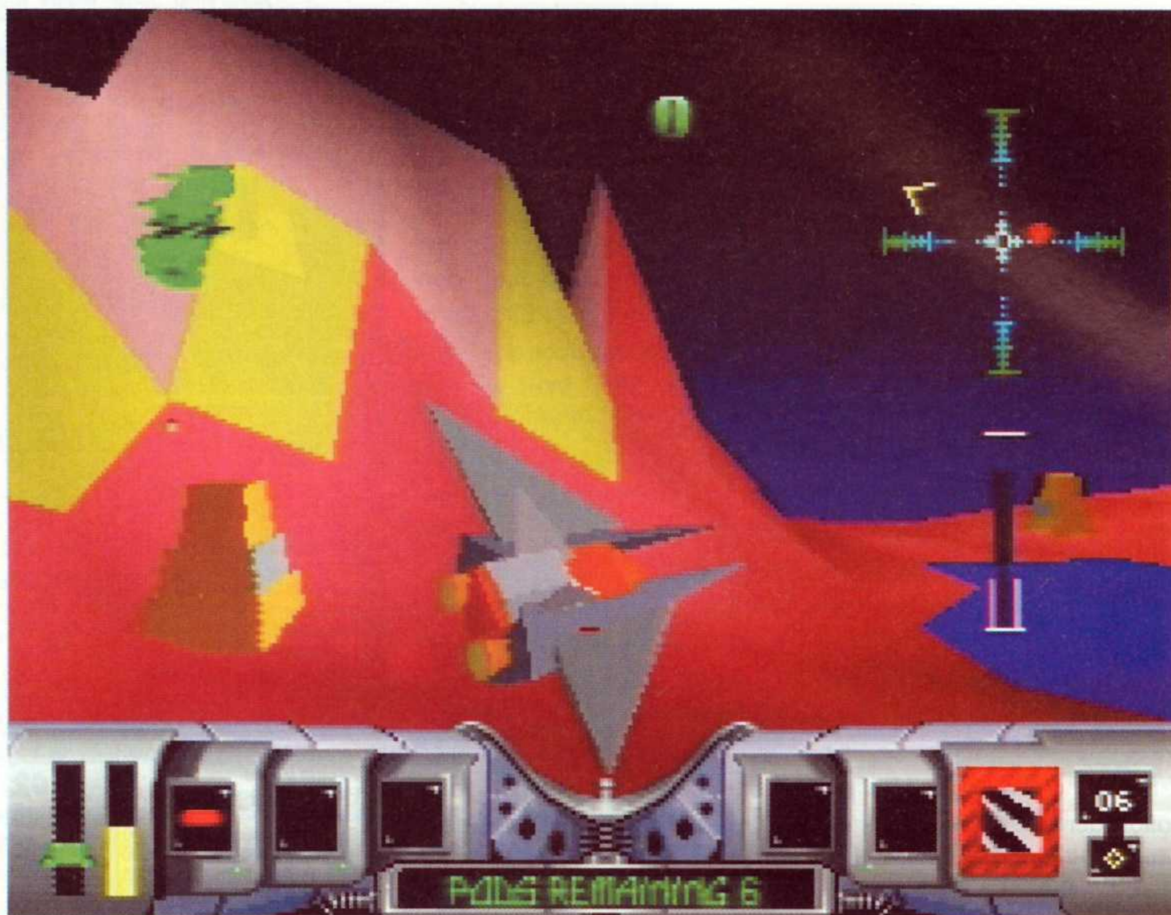
Cybermorph macht ausgiebigen Gebrauch vom eingebauten "Z-buffering" des Jaguars. Dies erlaubt die Darstellung von vielen Polygonen, die miteinander in Relation stehen, gleich ob sie zusammen ein Objekt bilden oder sich gegenseitig überlappen.
