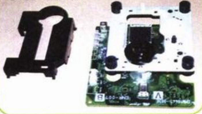
렌즈부를 분해한 모습. 렌즈 교체 시에는 사진 위쪽에 보이는 렌즈의 핵심 부품만 교체해주면 된다
