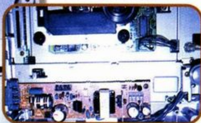
220V에 전원을 연결하면 새턴 쪽쪽 이단에 있는 구리코일을 감은 부분이 터져버리고 전원이 차단된다. 구리코일 우측에 있는 것이 콘덴서
