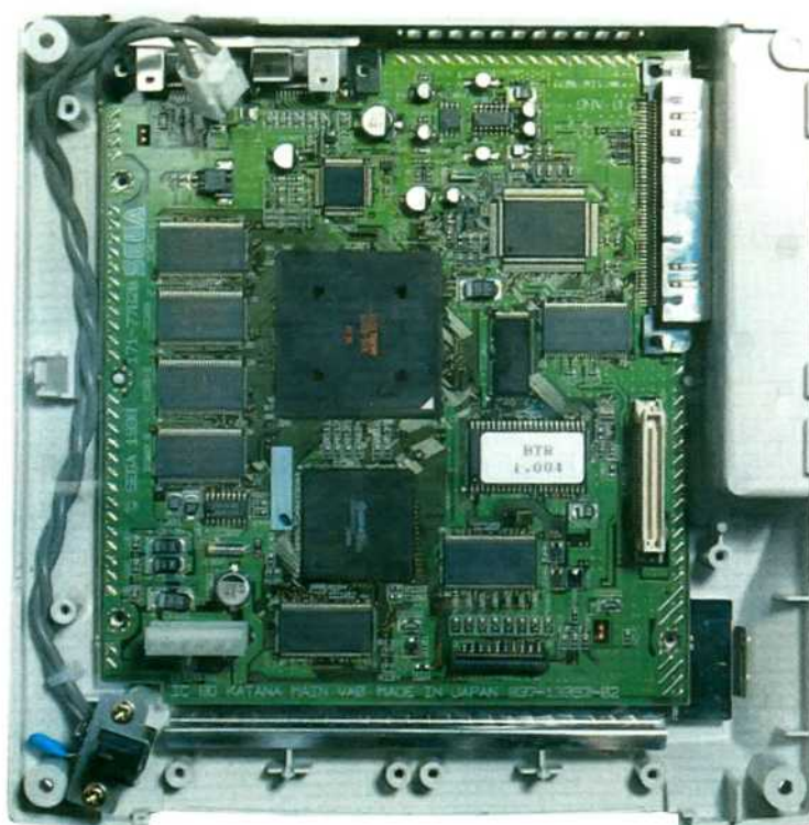
Beispiel Dreamcast: Der BIOS-Chip (BTR 1.004) auf der DC-Hauptplatine enthält wie die BIOS-EPROMs von N64 und PlayStation grundlegende Befehle, die für das Konsolen-Benutzermenü oder zum Start eines Spiels nötig sind. Über dem Chip liegt der 128KByte-Flash-RAM-Baustein, auf dem persönliche Informationen, wie Datum, Urzeit und Sprache, abgelegt werden können
