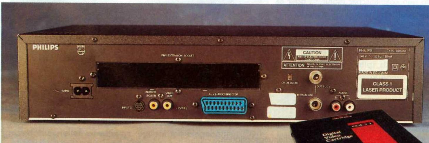
● Auf der Rückseite des CD-i 210 befinden sich: ein 21 Pin SCART-Anschluß, Audio und Composite Video RCA-Buchsen sowie der nach hinten versetzte FMV-Port für die Verbindung mit der DV-Cart.
