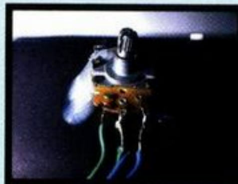
핸들을 부착하기 전에 먼저 가변저항을 케이스에 고정해야 한다. 가변저항을 원하는 위치에 정확히 다음의 사진과 같이 부착하도록 하자
