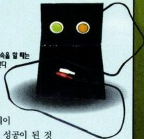
액셀, 브레이크의 케이스는 다음과 같은 디자인이 무난하다. 케이스를 잘라 낸 후에는 버튼 구멍을 뚫는다. 버튼을 버튼 구멍에 부착한 후 버튼의 각각의 단자에 AV선을 다음 사진과 같이 납땜한다
