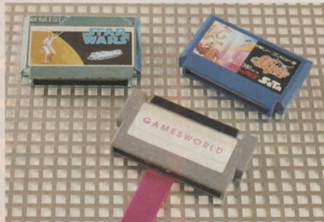
Der Japan-Adapter und ein angestöpseltes japanisches Modul sind genau so groß wie ein "normales" deutsches Cartridge
