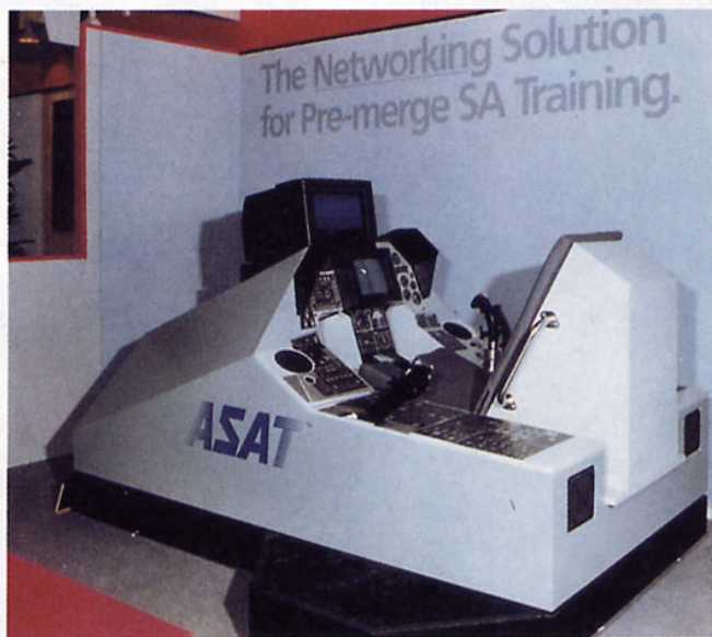
"ASAT" ist ein neuer Profi-Flugsimulator der amerikanischen Luftwaffe. Als Software läuft die IBM-AT-Version von Spectrum Holobytes viel gelobten Bestseller "F-16 Falcon".
