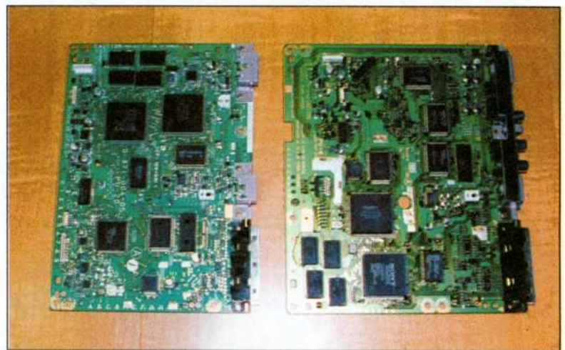
Kutaragis neuester Clou: Das übersichtliche Innenleben der neuen PlayStation-Hardware SCPH-7000, die um rund 10% kleiner geworden ist und 1800 Yen (ca. 25 DM) weniger kostet als der Vorgänger
