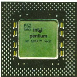
Das ist er, der neue MMX-Prozessor von Intel. Durch den vergrößerten Cache bringt er auch ohne spezielle MMX-Software etwas mehr Leistung.
