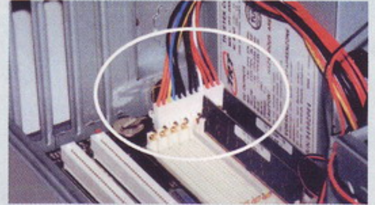
napajanje osnovne plošče priklopimo tako, da sta para črnih žic skupaj in na sredini - za vsak primer preveri v navodilih
