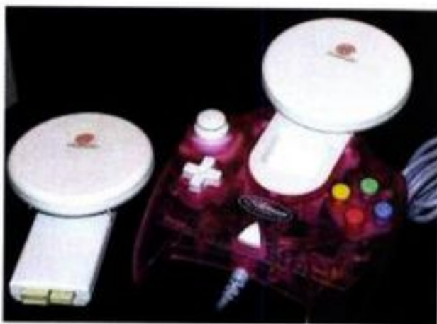
▲ 이것이 컨트롤러 위쪽에 접속하는 스위치와의 연동 장치이다. 손목시계형 단말기와는 무선으로 데이터를 주고 받는다
