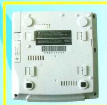
**Von unten:** Mysteriös sind die vier Vertiefungen, die eindeutig zum Einrasten eines Unterbaus sind. Links oben ist das Wechsel-Modem zu sehen
