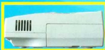
**Von rechts:** Hinter den Schlitzen verbirgt sich ein kleiner Lüfter, der die Konsole mit ausreichend Frischluft versorgt
