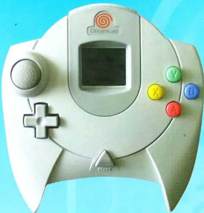
**Mit Speichermöglichkeit:** Ist das VMS eingesteckt, hat man zusätzlich ein kleines Display im Controller. Manche Spiele zeigen Zusatzinformationen darüber an
