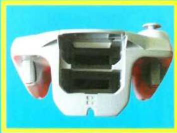
**Zweigleisig:** Der Controller bietet gleich zwei VMS bzw. einem VMS und dem bald erhältlichen Rumble-Zusatz Platz
