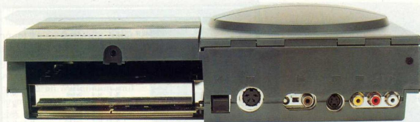
**Diese eindrucksvolle Anschlußreihe auf der Rückseite des CD 32 umfaßt Composite, RF und S-Video-Output, Stereo Audio-Phono-Anschlüsse sowie einen Erweiterungsport, über den man Add-ons wie ein FMV-Modul mit dem Gerät verbinden kann. Es gibt allerdings keinen RGB-Output für eine SCART-Verbindung.**
