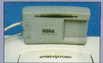
Der zusätzlich Schacht dient zur Aufnahme von Add-On-Cards
