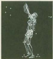
Hier seht Ihr die Roh-Entstehung eines Bewegungsablaufes nach dem Motion-Capturing-Verfahren
