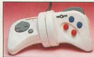
Der Ne-G-Con läßt sich in der Mitte um bis zu 135 Grad drehen
