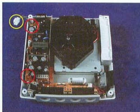
▲ Dreht die Konsole wieder um, so dass die vier Controller-Ports zu euch zeigen. Löst zuerst den weißen Netzstecker (gelber Kreis) und entfernt dann behutsam die zwei Schrauben (rot), die das Netzteil befestigen.
