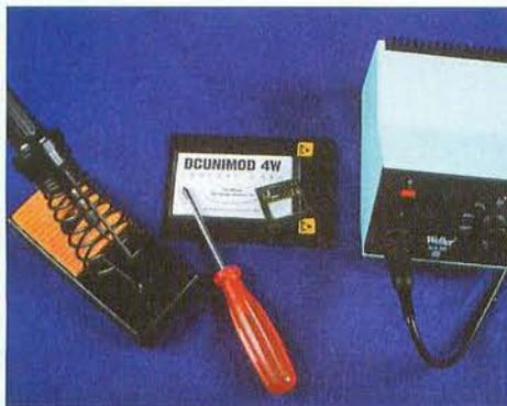
▲ Das benötigte Werkzeug: Lötcolben (nicht mehr als 300 Grad, feine Lötspitze), Lötzinn (1mm Durchmesser oder weniger) und ein Kreuzschlitzschraubenzieher. Bevor ihr loslegt: Netzstecker ziehen!!!
