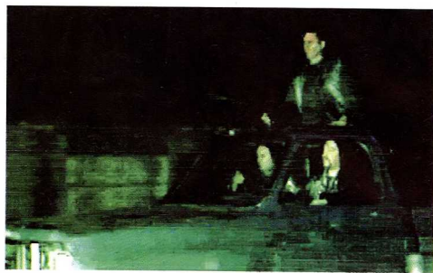
Im SVGA-Modus wird das Mehr an Details und Farben mit einem Interlaced-Modus erkauft: jede zweite Bildschirmzeile bleibt schwarz.
