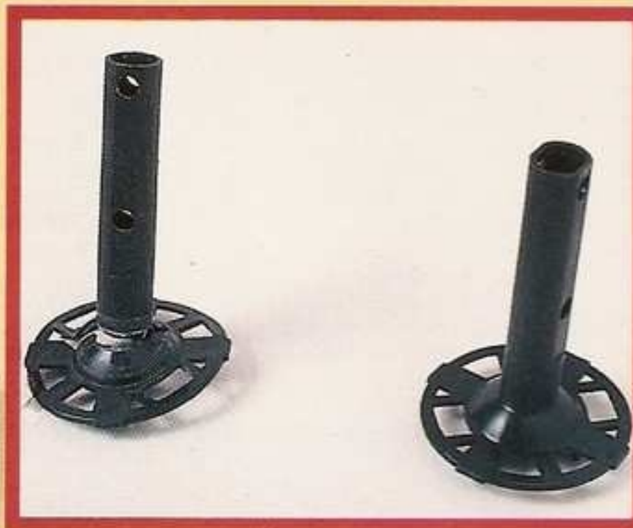
Um manche destruído e outro normal: eles não agüentam giradas muito radicais
