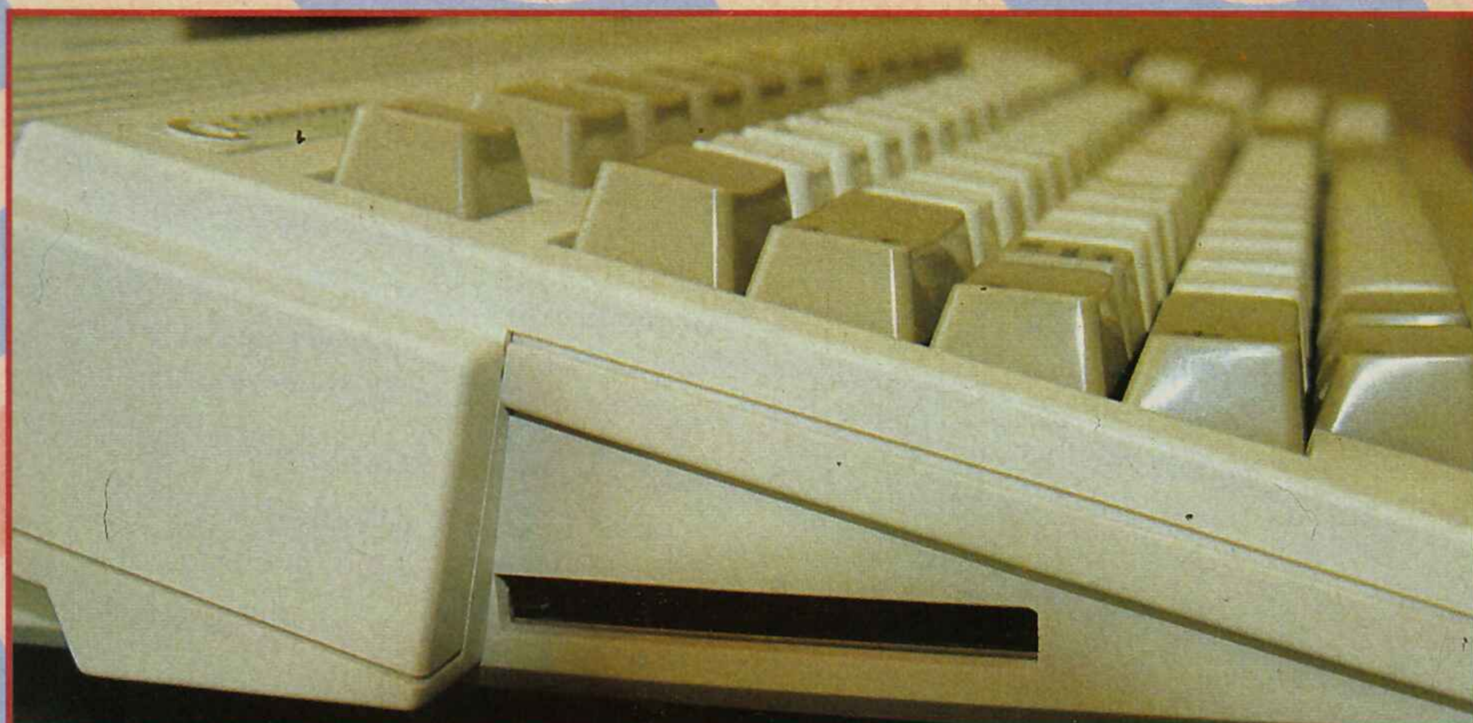
Sur le côté gauche, on trouve un connecteur de cartes PCMCIA qui peut servir à rajouter de la RAM ou à placer un DSP ou un Genlock, par exemple.
