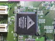
內建的ATA-100與RAID的控制晶片AMI MG80649
