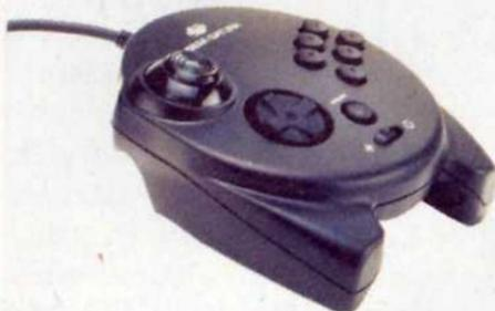
Das 3D-Pad verfügt über ein analoges und digitales Steuerkreuz
