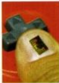
▲ 이것이 바로 차세대 프로세서 'Gekko(月光)'. IBM의 최신 구리배선 기술을 이용하여, 보다 조밀하고 복잡한 CPU를 구성할 수 있게 해준다.
