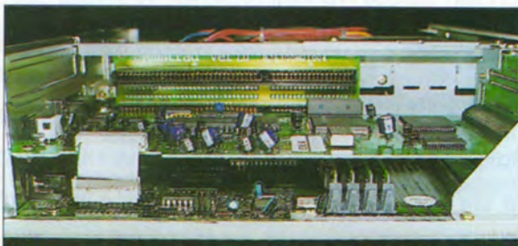
Η πλαινή όψη του MEGA PC. Διακρίνουμε τη σύνδεση SEGA-VGA, τη θύρα επέκτασης, και τα SIMMS
