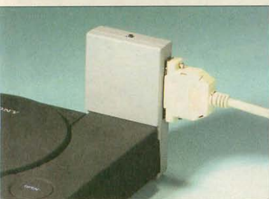
So wird der Xploder an die PlayStation angeschlossen. Das Kabel führt zu einem PC, muß aber nicht benutzt werden.
