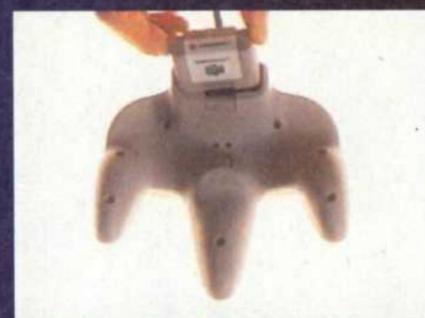
Auf der Unterseite des Pads befindet sich ein Slot für das Memorypack
