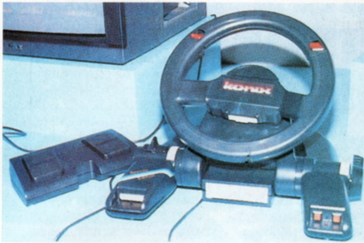
La console Konix è interamente programmabile. A seconda del gioco, si può adattare il volante di un'automobile, la guida di una moto o la cloche di un aereo.
