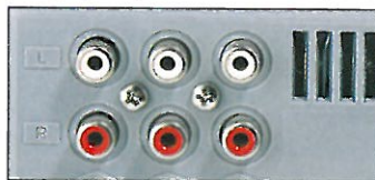
En las clavijas cinch se pueden conectar la televisión, el video y la consola.
