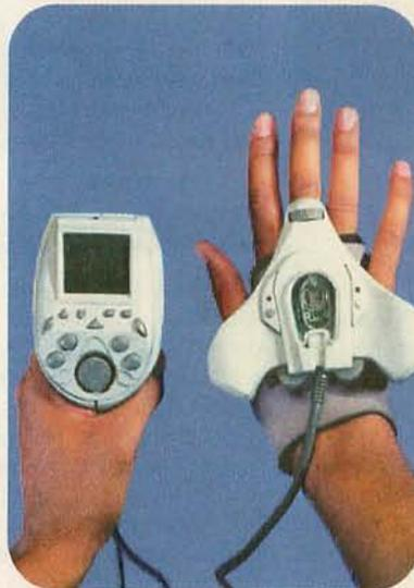
Möglich wird dies durch einen neu integrierten G-Tilt-Chip, der seine relative Position zum Gravitationsfeld der Erde bestimmen kann.
