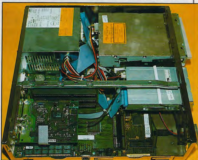
Το εσωτερικό του υπολογιστή όπως φαίνεται από τα αριστερά. Κάτω αριστερά βλέπετε τον controller του CD-ROM και τα SIMMS της μνήμης, κάτω δεξιά την πλακέτα του υπολογιστή. Στα δεξιά βλέπετε το drive (μέση) και το CD-ROM (πάνω)
