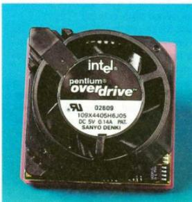
◀ Beim Pentium Overdrive/166-MMX von Intel ist der Lüfter fest mit der CPU verbunden.
