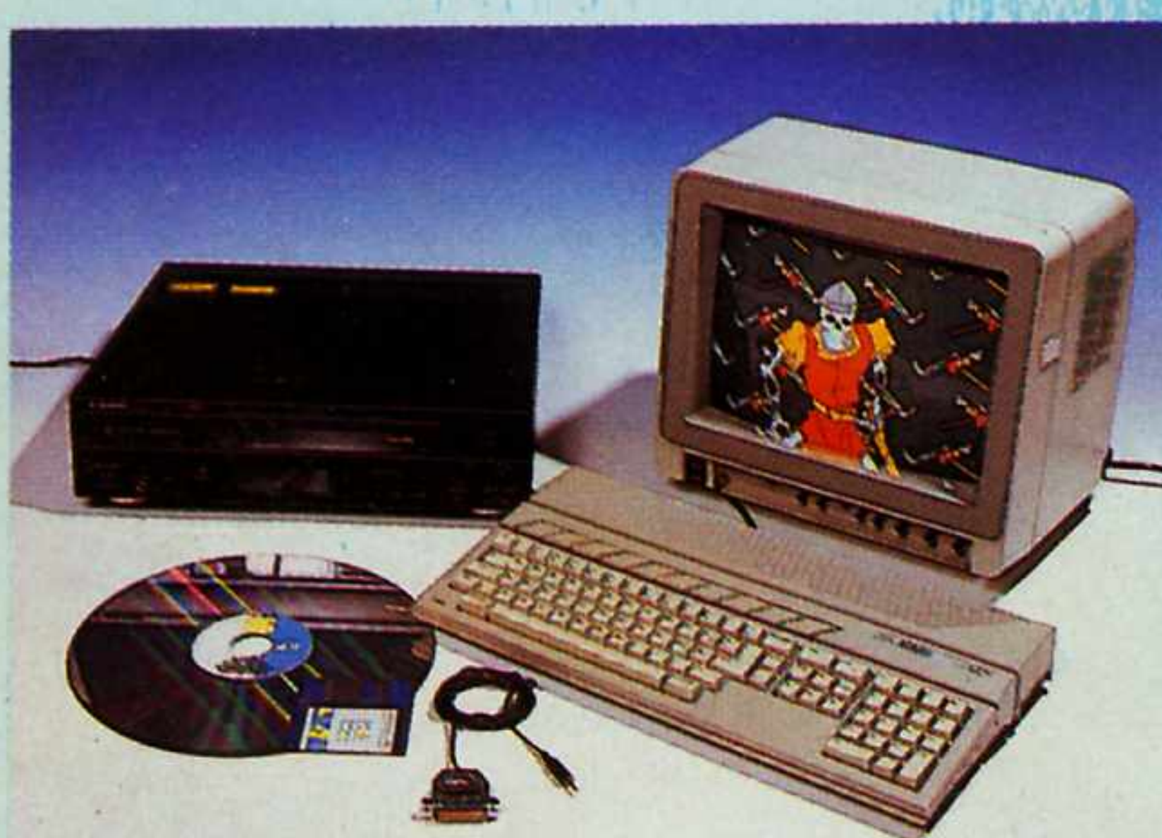
LUST AUF LDG: Player, Monitor, Computer (hier ATARI ST), Steuersoftware auf 3,5" Diskette, Interface, LDG-Disc
