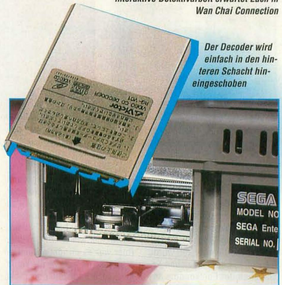
Der Decoder wird einfach in den hinteren Schacht hineingeschoben
