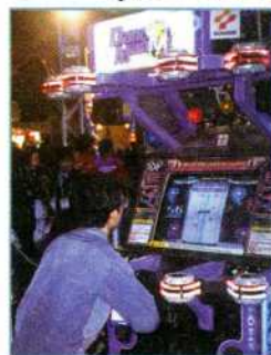
Konamis "Dance Maniax"-Automat registriert Bewegungen über Lichtsensoren
