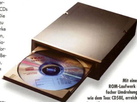
Mit einem CD-ROM-Laufwerk mit 8-facher Umdrehungszahl, wie dem Teac CD58E, erreichen Sie Datenübertragungsraten von bis zu 1.200 KByte pro Sekunde.
