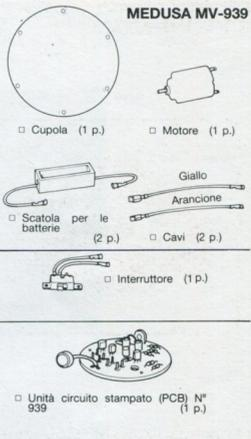
Il MEDUSA possiede un solo motore che permette il movimento del Robot in un solo senso tramite una serie di ingranaggi riduttori. Questo motore viene comandato dai due transistors che fungono da
