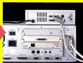
◆あとはSCSIケーブルでつなげば終わり。SCSIケーブルにはフルとハーフという、幅の違う物があるので注意しよう。
