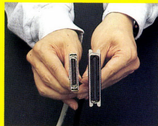
◆これがSCSIケーブル。左がハーフで、右がフル。買うときは確認してからね。
