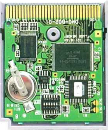
Einblick in ein Game-Boy-Modul: Die Programminformationen eines Moduls werden in so genannten ROM-Bausteinen gespeichert. Über das Bus-System (die goldenen Leiterbahnen an der Oberkante) fließen Datenströme
