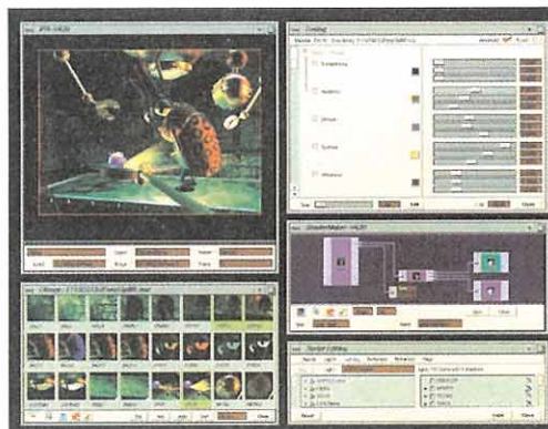
El IPR (Interactive Photorealistic Rendering) permite cambiar los materiales e iluminación de una escena de un modo totalmente interactivo y casi en tiempo real.
